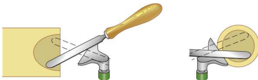
Рис. 4.27. Приёмы внутреннего точения
