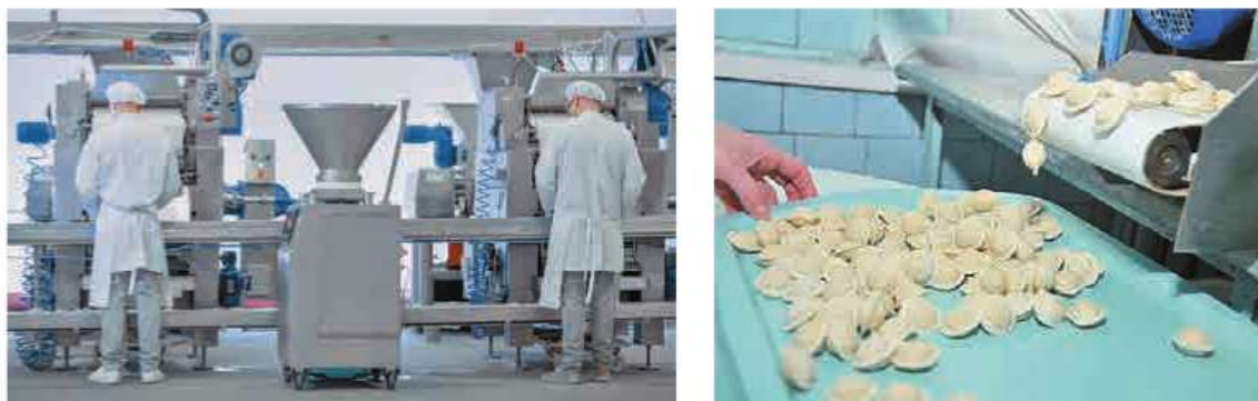
Рис. 7.27. Формованиепельменей в условиях производства (пельменный полуавтомат)
