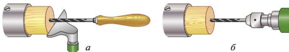
Рис. 4.26. Приёмы сверления отверстий проходниками: а — с помощью подручника; б — с использованием задней бабки
