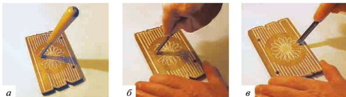
Рис. 8.24. Техника резьбы: а — начальное положение полукруглой стамески при наколке; б — приём наковки; в — приём подрезки
