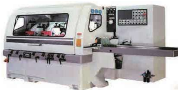
Рис. 4.34. Универсальный строгальный станок для фрезерования заготовок из древесины с четырёх сторон
