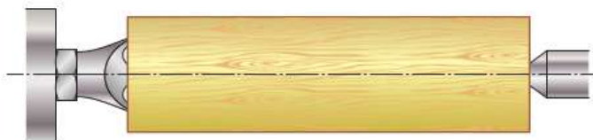
Рис. 4.16. Закрепление заготовки в центрах
