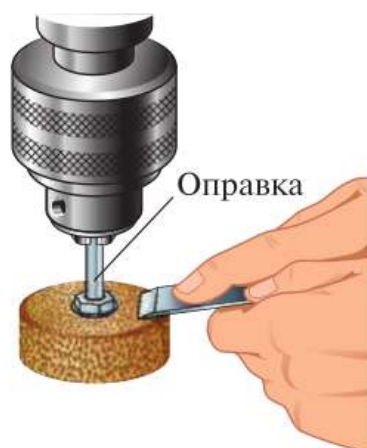
Рис. 11.10. Рабочий момент доводки режущего инструмента
