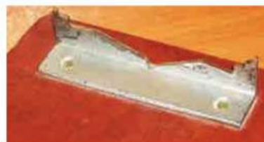
Рис. 11.5. Приспособление для натяжения пилки ручного лобзика: а — общий вид; б — фиксатор рамки; в — направляющий рамки
