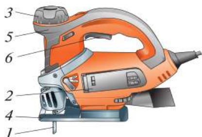
Рис. 5.58. Электрический лобзик: 1 — стальная пила; 2 — электродвигатель с редуктором; 3 — регулятор; 4 — опорная лыжка; 5 — рукоятка; 6 — выключатель
