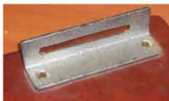
Рис. 11.5. Приспособление для натяжения пилки ручного лобзика: а — общий вид; б — фиксатор рамки; в — направляющий рамки
