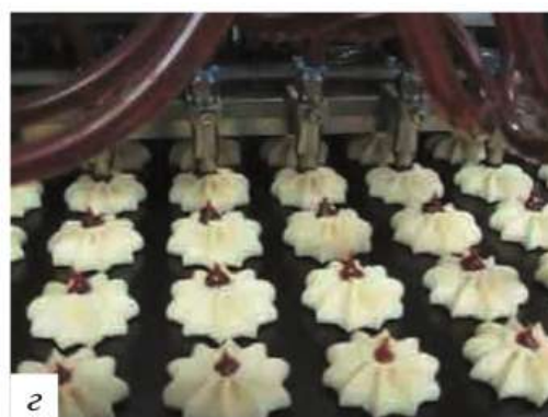
Рис. 7.17. Кондитерское оборудование: а — тестомесильная машина; б — оборудование для дозирования начинки (наполнение эклеров); в — глазировочное оборудование; г — отсадочная машина (печенье курабье)
