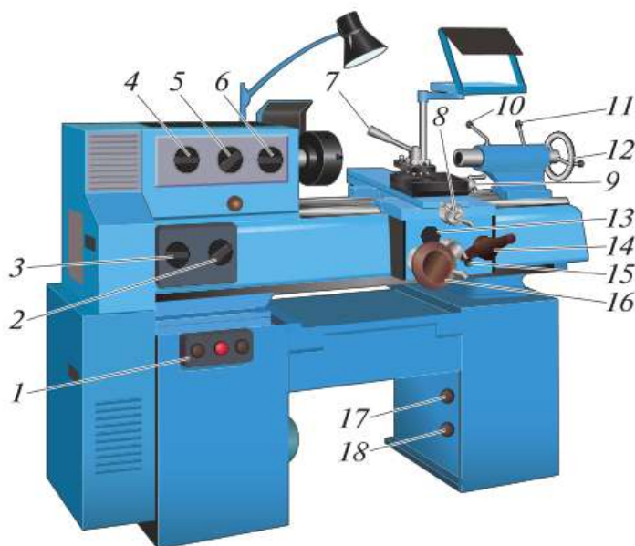
Рис. 5.7. Система управления станком ТВ-6: 1 — кнопочная станция; 2 — рукоятка включения ходового вала и ходового винта; 3 — рукоятка установки величины подачи и шага резьбы; 4 — рукоятка изменения направления подач; 5, 6 — рукоятки установки частоты вращения шпинделя; 7 — рукоятка крепления резцедержателя; 8 — рукоятка поперечной подачи; 9 — рукоятка ручного перемещения верхних салазок; 10 — рукоятка крепления пиноли задней бабки; 11 — рукоятка крепления задней бабки; 12 — маховик перемещения пиноли; 13 — кнопка включения и выключения реечной шестерни; 14 — рукоятка включения гайки ходового винта; 15 — рукоятка включения продольной механической подачи; 16 — маховик ручного перемещения каретки; 17 — пакетный выключатель сети (общий); 18 — пакетный выключатель местного освещения
