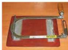
Рис. 11.5. Приспособление для натяжения пилки ручного лобзика: а — общий вид; б — фиксатор рамки; в — направляющий рамки
