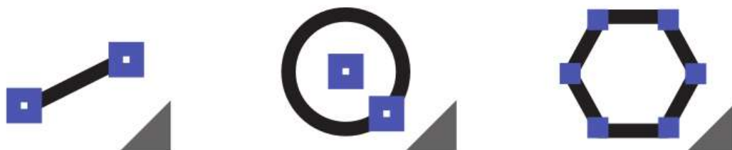
Рис. 3.7. Инструменты панели «Геометрия» в программе Компас 3D: «Отрезок», «Окружность», «Многоугольник»
