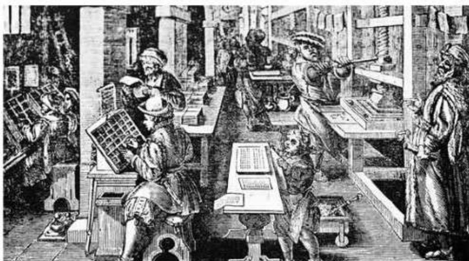
Типография. Гравюра XVI в. Слева — наборщики из касс набирают текст. Справа — работник намазывает набор краской, покрывает его бумагой, трёт сверху щёткой или прижимает прессом
