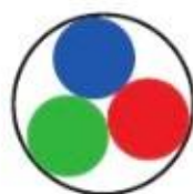
Рис. 4.3. Пиксель состоит из трёх точек красного, зелёного и синего цветов
