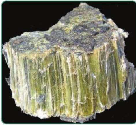
Рис. 56. Асбест обладает волокнистой структурой
