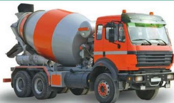
Рис. 60. Цементный раствор перевозят в специальных автомашинах
