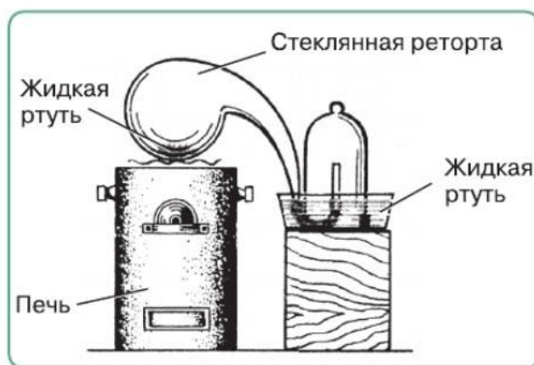
Рис. 40. Установка Лавуазье для изучения состава воздуха
