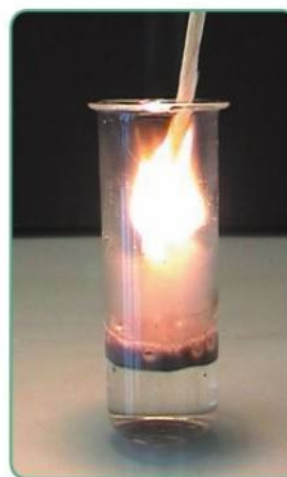
Рис. 44. Получение кислорода разложением пероксида водорода и обнаружение с помощью тлеющей лучинки
