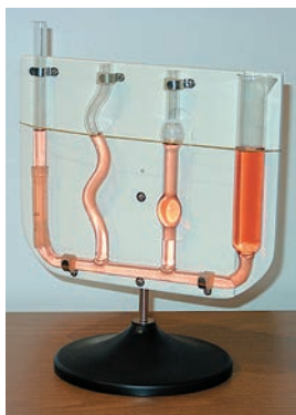
Рис. 121. Прибор, демонстрирующий установление одинакового уровня жидкости в сообщающихся сосудах
