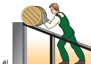
Рис. 168. Использование для поднятия грузов: а — наклонной плоскости; б — блоков
