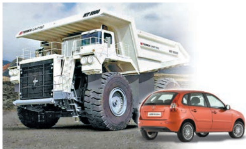
Рис. 96. Давление на поверхность уменьшается с увеличением площади опоры (колёс автомобиля)
