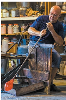
Рис. 31. Выдувание вазы из жидкого стекла
