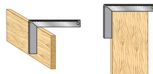
Рис. 4.32. Контроль строгания столярным угольником
