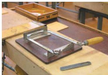
*Рис. 8.14. Приспособление для закрепления пилки ручного лобзика*
