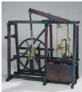
*Рис. 10.7.* Паровая машина Дж. Уатта
