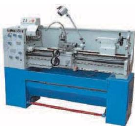
Рис. 11.8. Токарно-винторезный станок по металлу
