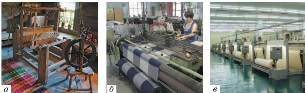
Рис. 6.7. Ткацкие станки: а — деревянный ручной; б — механический; в — автоматизированный
