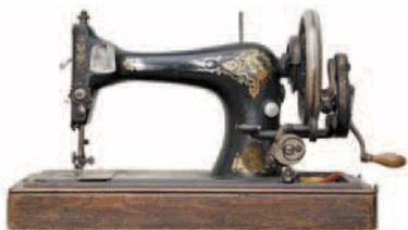
Рис. 6.15. Швейная машина с ручным приводом
