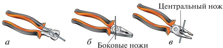
Рис. 5.16. Приёмы откусывания проволоки: *a* — кусачками; *б* — боковыми ножами пассатижей; *в* — центральным ножом пассатижей
