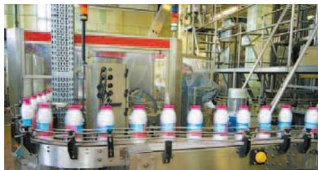
Рис. 7.3. Линия по производству и разливу молочной продукции
