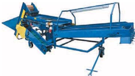
Рис. 7.17. Установка для сортировки картофеля
