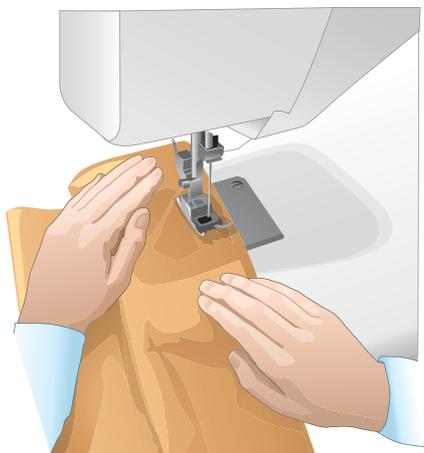
Рис. 6.21. Правильное положение рук при работе на швейной машине
