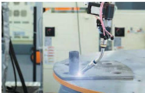
Рис. 10.9. Лазерная сварка
