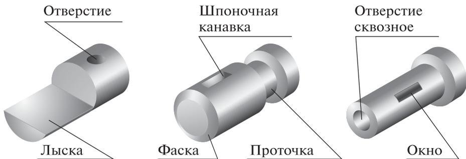
Рис. 3.8. Примеры конструктивных элементов деталей
