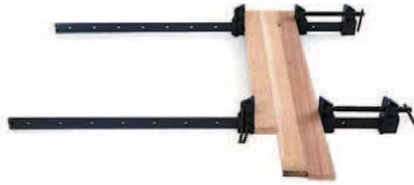
Рис. 4.43. Склеивание обрезных досок с использованием струбцин
