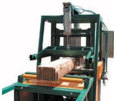
Рис. 4.7. Процесс распиловки бревна на лесопильном станке (пилораме)
