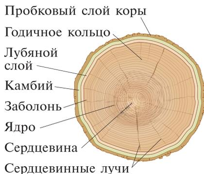
Рис. 4.5. Торцевой (поперечный) срез ствола
