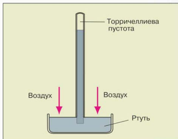
Рис. 95. Барометр Торричелли и принцип его действия
