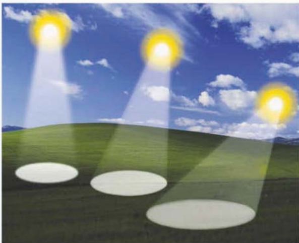
Рис. 93. Поступление солнечной энергии при разном угле падения солнечных лучей в течение дня
