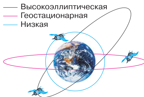
Рис. 42 Орбиты искусственных спутников Земли
