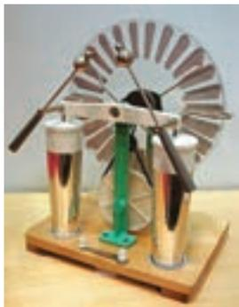
Рис. 72. Электрофорная машина
