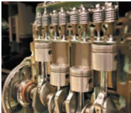
**Рис. 50.** Четырёхцилиндровый карбюраторный двигатель
