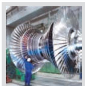
Ротор паровой турбины
