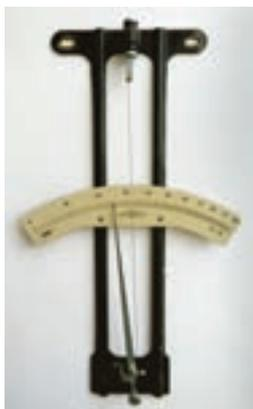
Рис. 38. Волосной гигрометр
