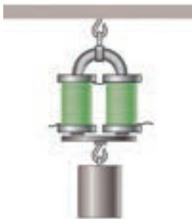
Рис. 136. Дугообразный электромагнит
