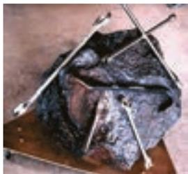
**Рис. 116.** Притяжение металлических тел естественным магнитом
