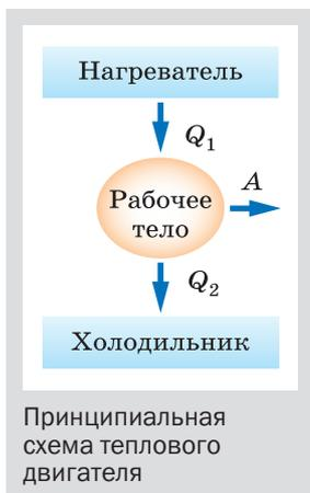
Обозначим количество теплоты, полученное рабочим телом от нагревателя,  $Q_1$ , количество теплоты, отданное рабочим телом холодильнику,  $Q_2$ , работу, совершённую двигателем,  $A$ . Тогда  $A = Q_1 - Q_2$ . В действительности совершённая работа ещё меньше. Это связано с нагреванием деталей двигателя, наличием трения между ними и т. д.
