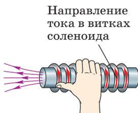
**Рис. 133.** Определение направления линий магнитного поля внутри соленоида
