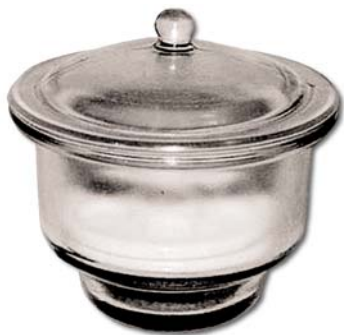
Рис. 60. Эксикатор — сосуд, в котором высушивают и хранят вещества, поглощающие влагу из воздуха. Фосфорный ангидрид помещают в нижнюю часть эксикатора
