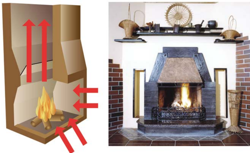
Рис. 37. Топка камина. При устройстве печей и каминов всегда стремятся создать тягу
