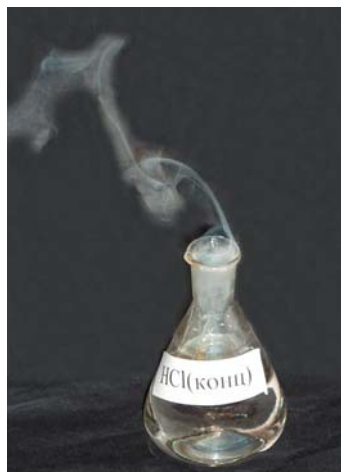
Рис. 55. Открытая склянка с соляной кислотой «дымит» на воздухе — из неё выделяется хлороводород
